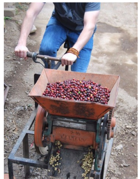
コーヒー豆の外皮と果肉を取り除く自転車駆動パルパー [皮と果肉を除去する機械]。
