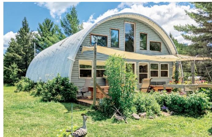
クオンセットハットは、亜鉛メッキ鋼板の波板でできた軽量な構造で、内壁の支持を必要としない。
